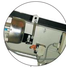
Automatische Laufunterbrechung durch Federstütze
