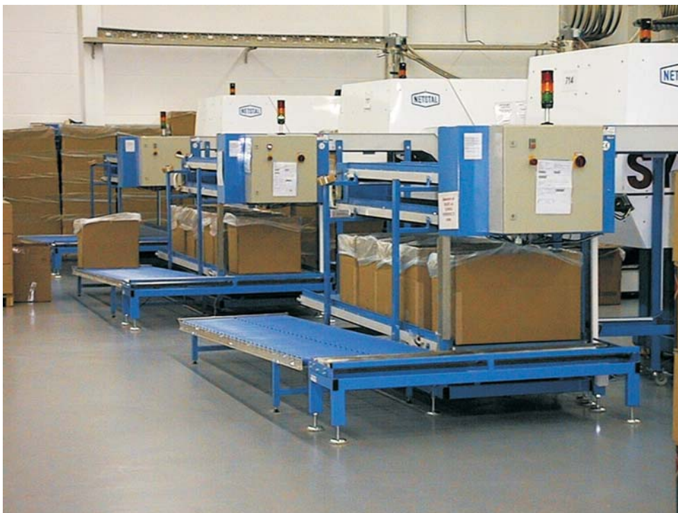
Abb. 2 Vollautomatische Abwiegestation für die Kunststoffindustrie
